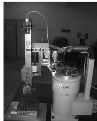
图 5 机械臂的手眼系统 Fig. 5 Eye-in-hand system of manipulator
